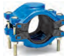
Серия 253 Универсальный ответвительный / ремонтный тройник Supa DN 80-300 для газа: PN 7 для воды: PN 16 GGG-40
