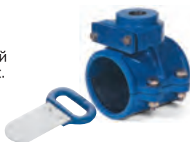
Серия 727/10 Ответвительный хомут для сверления под давлением, с заслонкой для ПВХ и ПЭ труб GGG-40 63-200 мм BSP 1/2" - 2"
