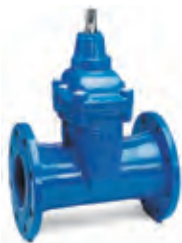
Серии 02 и 20 Фланцевая клиновая задвижка DN 40-500 PN 10 или 16 GGG-50 По запросу: • заменяемое уплотнение штока • внутри эмаль • PN 25
