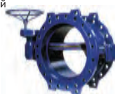
Серия 756 Дроссельный затвор, с двойным эксцентриком. Конструкция с встроенным седлом в проходном канале DN 700-2200 PN 10 или 16 GGG-50 По запросу: • с заменяемым седлом из пушечной бронзы • с заменяемым седлом из нерж. стали
