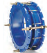
Серия 265 Соединитель фланцевый демонтирующийся, для всех типов труб с фланцевыми соединениями DN 300-1200 PN 10 или 16 Сталь по EN 10025
