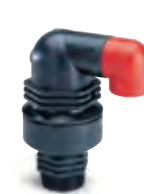
Серия 701/40 Комбинированный воздушный клапан двойного действия с резьбой BSP 3/4", 1" или 2" DN 20, 25 или 50 PN 10 : 3/4" и 1" PN 16 : 2" Усиленный нейлон
