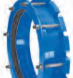
Серия 260 Сборная муфта DN 350-1200 для воды: PN 8 до 16 Сталь 37.0
