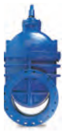
Серия 55 Фланцевая клиновая задвижка, DN 450-500-600 PN 10 или 16 Упруго-запирающаяся, полнопроходная, с заменяемым уплотнением штока, DN 80 байпас GGG-50
