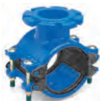
Серия 257 Универсальный ответвительный/ремонтный тройник Supa DN 100-300 для газа: PN 7 для воды: PN 16 GGG-40
