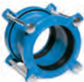
Серия 601 Соединительная муфта, DN 40-400 для газа: PN 7 для воды: PN 16 GGG-40 По запросу: • разные Ø на концах
