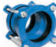
Серия 601 Соединительная муфта, DN 40-400 для газа: PN 7 для воды: PN 16 GGG-40 По запросу: • разные Ø на концах
