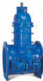
Серия 55 Фланцевая клиновая задвижка, DN 450-500-600 PN 10 или 16 Упруго-запирающаяся, полнопроходная, с заменяемым уплотнением штока, DN 80 байпас GGG-50
