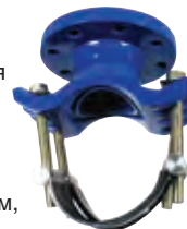
Серия 731 Универсальный хомут с фланцевым отводом PN 10 Материал : GGG-40 Для труб DN80-300 Размер отвода : DN40-200
