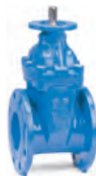
Серии 06 и 26 Фланцевая клиновая задвижка DN 40-300 PN 10 или 16 GGG-50 По запросу: • заменяемое уплотнение штока • внутри эмаль
