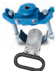
Серия 730/3 Универсальное ответвительное седло с заслонкой Ковк.чугун / нерж. DN 80-300 PN 16 / 250 ф.д. 2 Диапазон уплотн.: 88-365 мм BSP 1/2" - 3"
