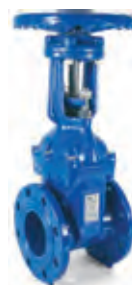
Серия 06/89 Задвижка клиновая фланцевая с выдвигным штоком Межфланц. расстояние по DIN F4 Из ковкого чугуна клин обрезинен EPDM DN 50-400
