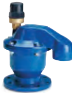
Серия 701/50 Комбинированный воздушный клапан двойного действия с фланцем на впуске DN 50-200 PN 16 Серый чугун или усиленный нейлон
