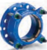
Серия 623/10 Раструбный фланцевый соединитель Supra Plus™ с устойчив. к растяжению уплотнит. кольцом для ПЭ труб и труб из твердого ПВХ DN 40-300 минимум GGG-40
